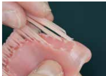
Veloce rimozione delle strutture di supporto (pianificazione possibile con le stampanti 3D SolFlex)
