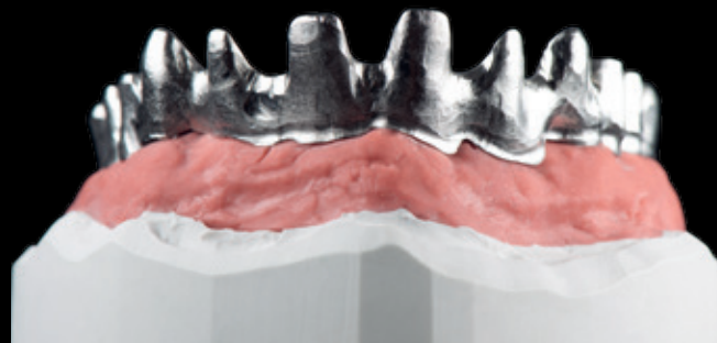
Abb. 2: Die gefräste Sekundärstruktur auf dem Modell. Fig. 2: The milled secondary structure on the model.
